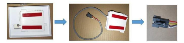
5- Após retirar a fita adesiva do módulo WIFI, encaixe na tampa frontal da unidade interna ao lado do display;
