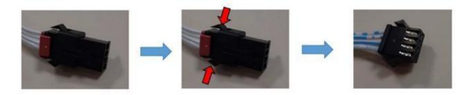
4- Abra a embalagem do módulo WIFI, conecte o plug WIFI no conector da placa da unidade interna;
