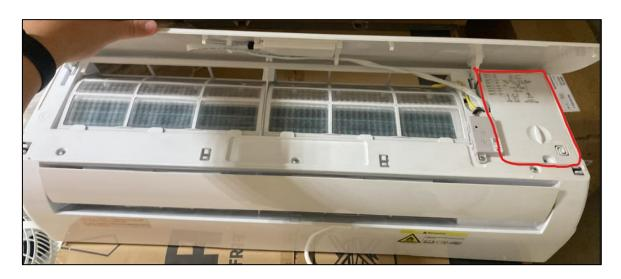
2- Identifique a borneira de conexão elétrica, e desacople-a retirando o parafuso indicado;
