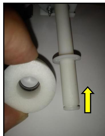
2. Com o auxílio de um multímetro na escala de teste de continuidade, realizar teste no conector da bóia, movimentando a bóia para cima e para baixo verificando se está abrindo e fechando o contato.
