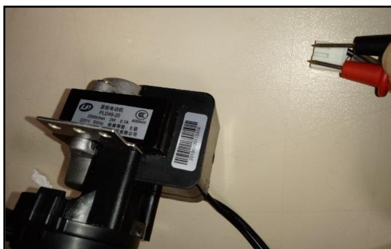
Com o produto ligado na tomada, com o auxílio de um multímetro na escala de tensão (ACV), meça entre os contatos do Conector CN24, o conector fornece a tensão nominal da bomba.
