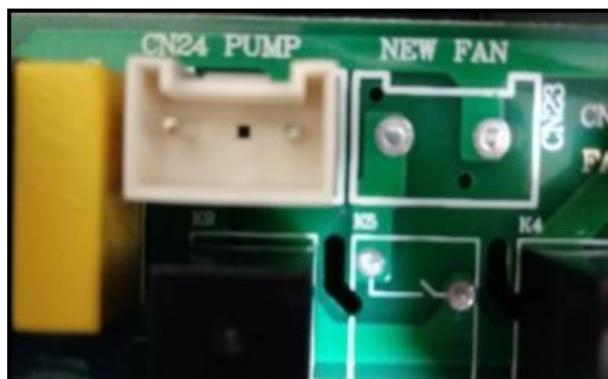
Caso a bomba de drenagem esteja atuando e não seja constatado defeitos nos testes dos componentes do produto, o erro está relacionado a instalação do sistema de drenagem do produto, para esses casos deverá ser verificado se o sistema de drenagem está conforme manual do produto, caso não esteja, deverá ser realizado a alteração no sistema de drenagem.
