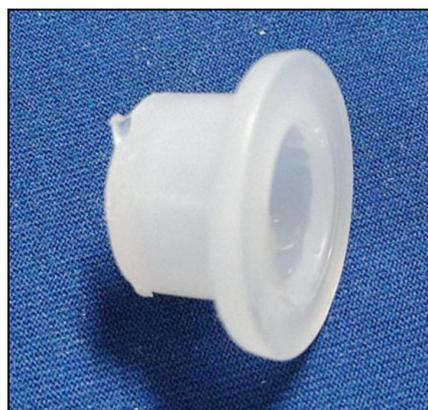
Figura 1: Altura indicada para mangueira de dreno e tampão plástico encontrado em mangueira de dreno
