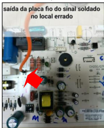
Imagem 1 – posição incorreta do fio ( P2 EARTH ).
